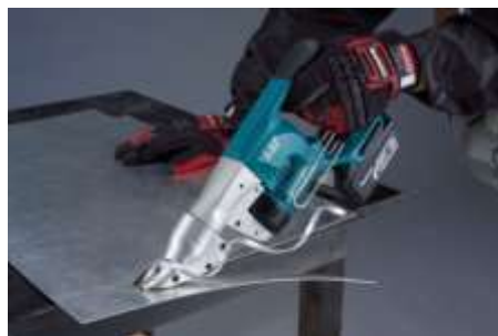
Figure 4.3 : découpage manuelle d'une feuille de tôle
