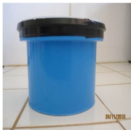
Figure 2.6 – Marineli Beaker contenant la source liquide radioactive de l'AIEA utilisée pour l'étalonnage en efficacité de la chaîne de détection de la spectrométrie \gamma en laboratoire [47].
