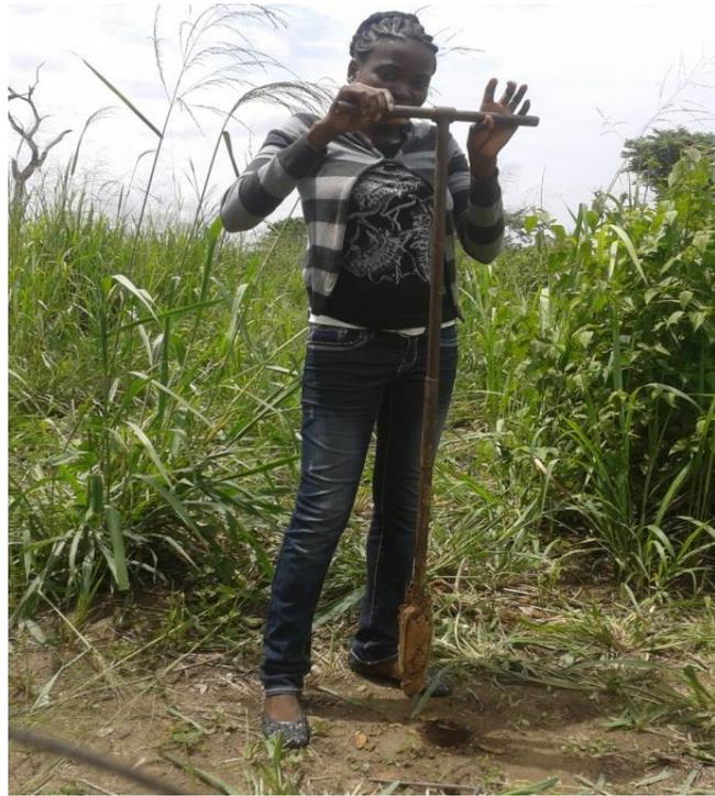
**Figure 16** : prélèvement d'argile à la tarière manuelle.
