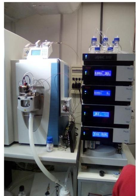
**Figure 34:** Appareil pour la Chromatographie en Phase Liquide à Haute Pression (CLHP) couplée à la spectrométrie de masse
