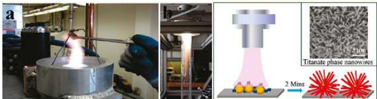
Figure I.21 : Photographie et représentation simplifiée du dispositif des plasmas micro-ondes à la pression atmosphérique pour la synthèse des nanofils de dioxyde de titane [107]
