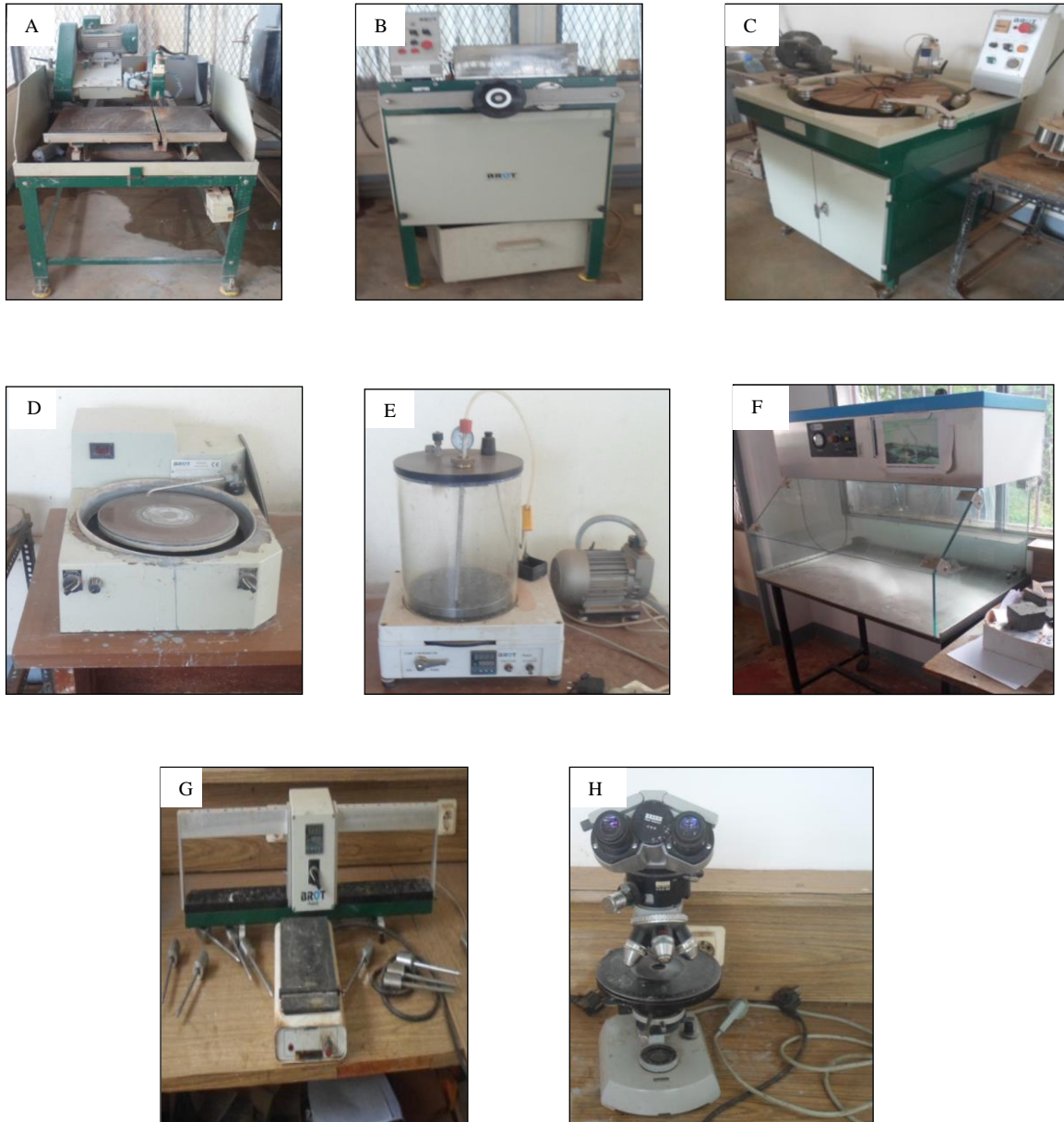
Figure 11 : Dispositif des matériels de réalisation des lames minces : (A) Tronçonneuse ; (B) Rectifieuse ; (C) Rodeuse ; (D) Prépolisseur ; (E) Stand d'imprégnation ; (F) Presse de collage à aspirateur ; (G) Plaque chauffante ; (H) Microscope
