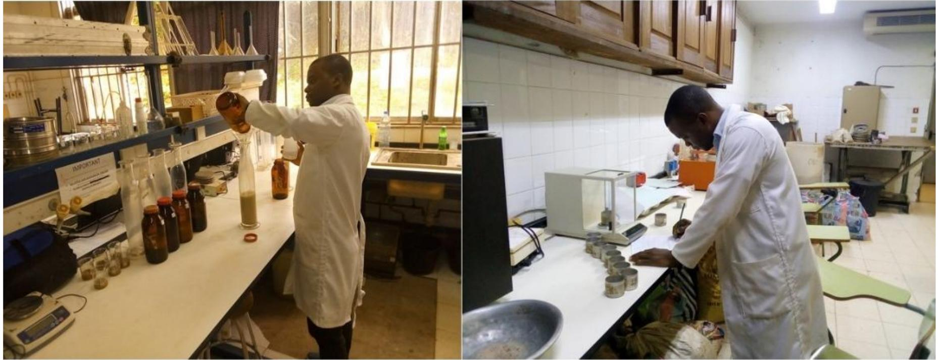
**Figure III. 10 :** Analyse granulométrique par sédimentométrie.
