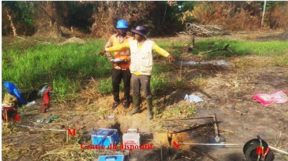
**Figure III. 3 :** Acquisition des données géo-électriques 1D à côté d'un puits : A-B électrodes d'injection de courant, M-N électrodes de mesure de potentiel.
