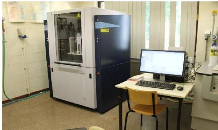
**Figure III. 14 :** Diffractomètre Bruker Advance Eco.
