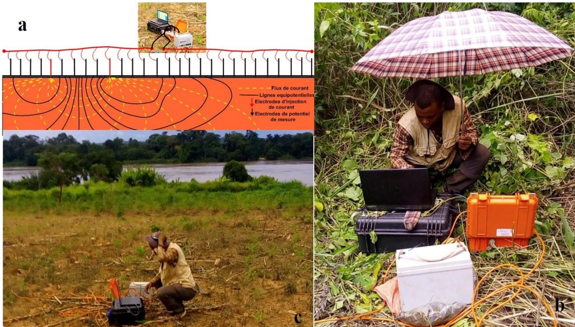
**Figure III. 4 :** (a) Croquis d'une mesure de champ pour le système ZZ Geo FlashRes-Universal 64 (à gauche) et la configuration de l'instrument ZZ Geo FlashRes-Universal 64/96 (à droite), (b et c) acquisition des données géo-électrique 2D
