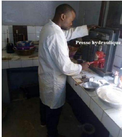
**Figure III. 13 :** Confection des éprouvettes à l'aide d'une presse hydraulique.
