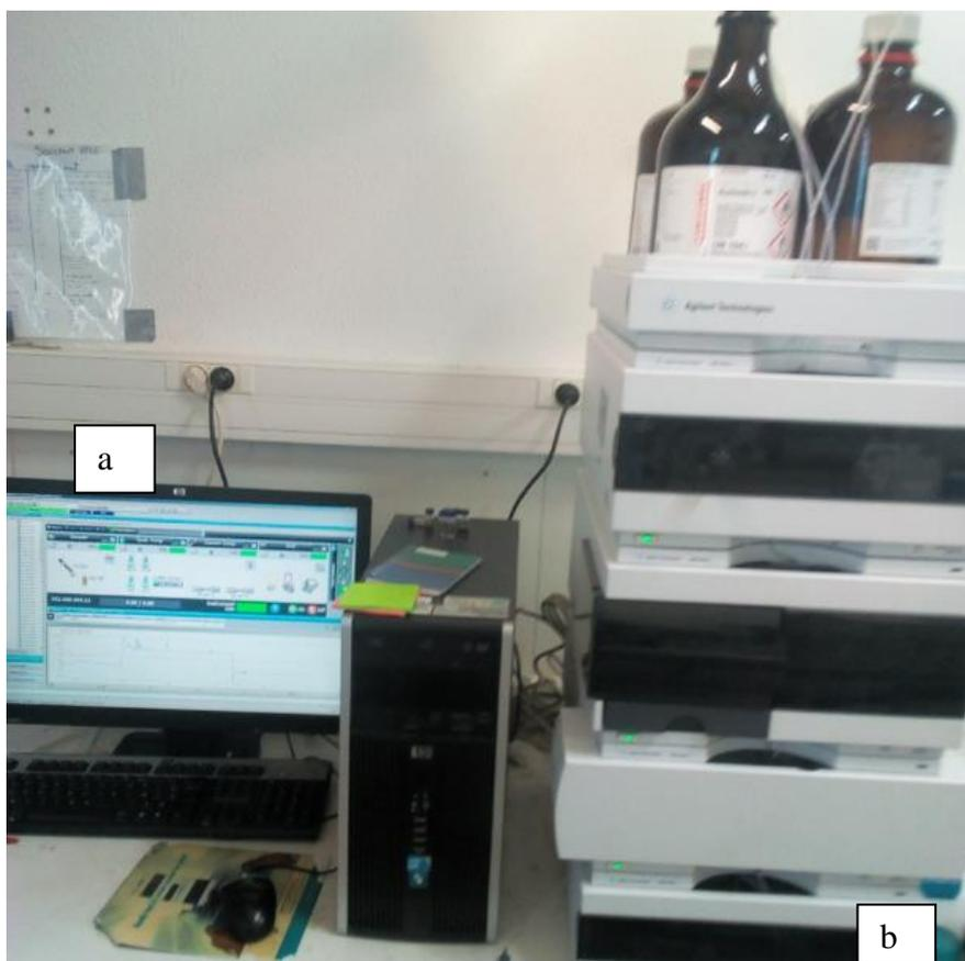
**Figure 11 :** Dispositif de la chromatographie liquide haute performance : a) Microordinateur b) Analyseur des extraits
