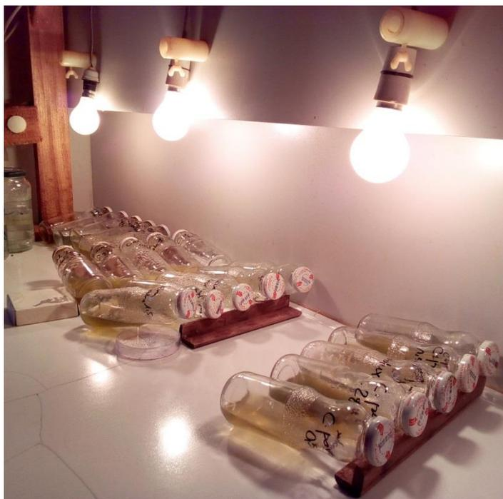
**Figure 15 :** Dispositif expérimental d'exposition des cultures sous différentes conditions lumineuses (Photo Metsopkeng, 2022).
