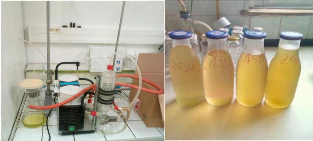
**Figure 14 :** Préparation des solutions d'extraits : a) Dispositif de filtration sous vide des extraits ; b) Différentes concentrations d'extraits filtrés sous vide.
