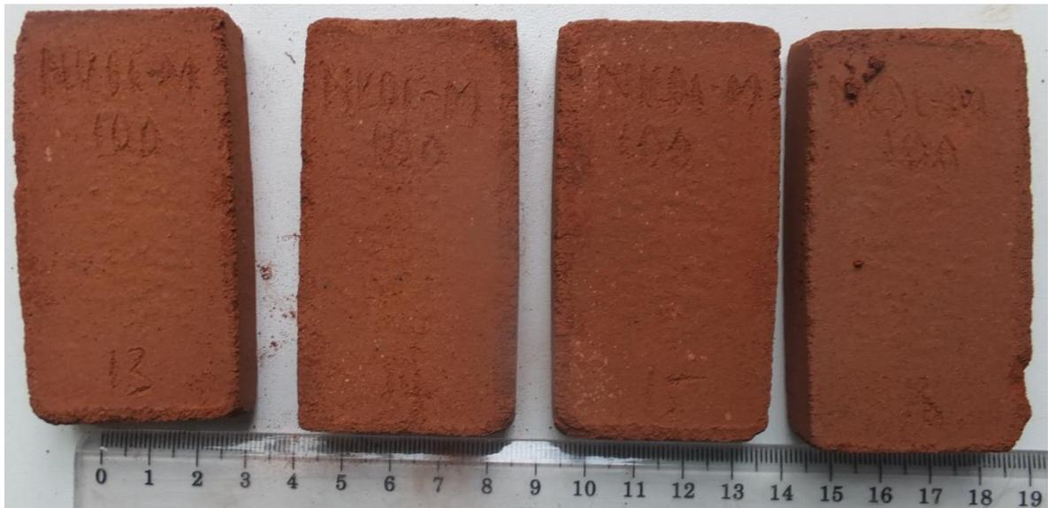
Figure 39. Faible cohésion – effritement de briquettes de Nkom (illustration pour NK\_100 après cuisson à 1050°C)
