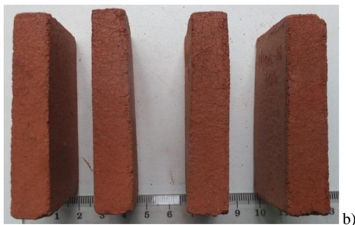
Figure 40 a et b. Distorsions observables sur les briquettes de Nsanmendouga (NS \_100) après cuisson à 1050°C
