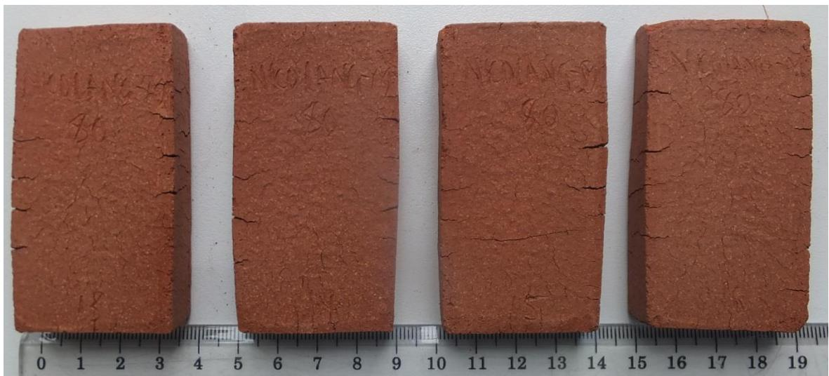
Figure 27. Faibles fissurations sur les briquettes à base d'argile latéritique de Nkolang (NA\_80 à 1050°C)
