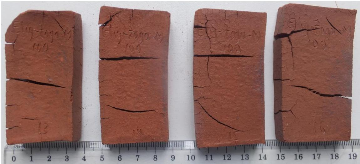
Figure 26. Fissurations importantes sur les briquettes à base d'argile latéritique d'Elig-Zogo (EZ\_100 à 1050°C)
