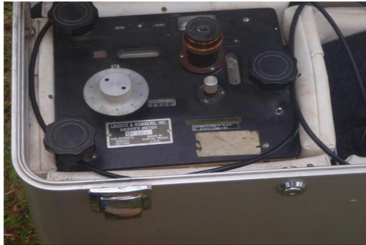
**Figure 2.4 :** Gravimètre Lacoste-Romberg dans son coffret
