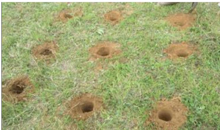
FIGURE 2.1 – Point de prélèvement constitué de neuf sous prélèvements.
