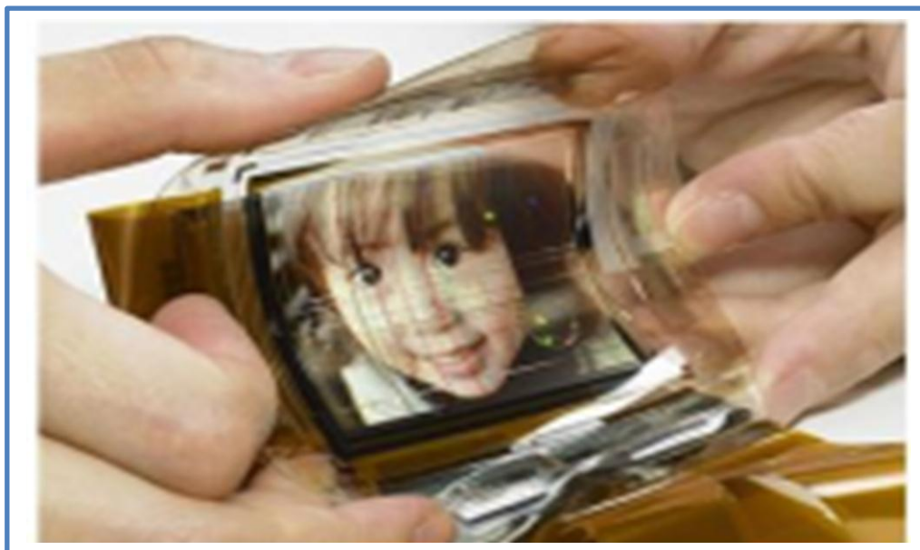
Figure 1.4: Application de l'électronique organique, écran OLED flexible utilisant des transistors organiques (sony) [38].
