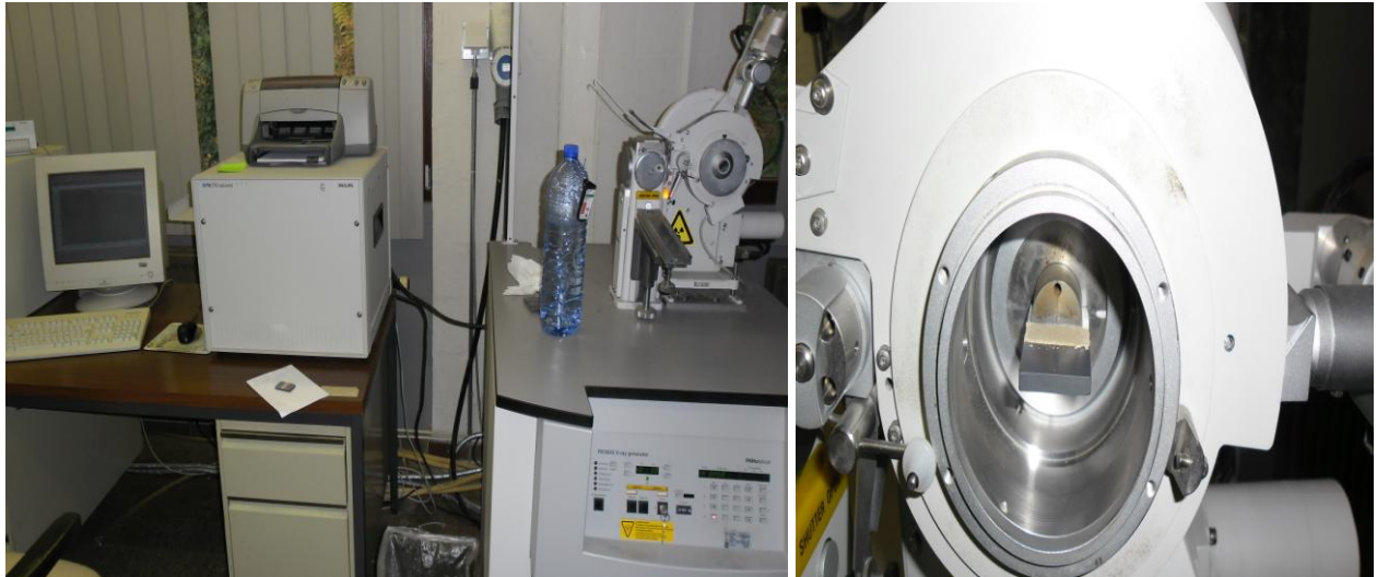
Figure 12 : Spectromètre de diffraction de rayons X (laboratoire de minéralogie, Université de Liège) (Photo Ngally).
