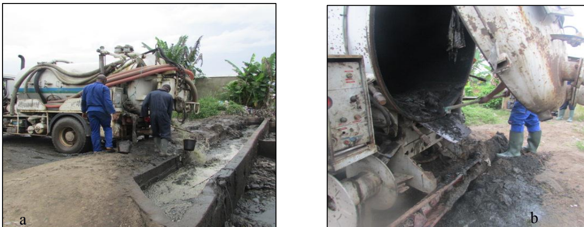
Fig. 25. Matériel utilisé lors du dépotage des boues au Bois des singes à Douala. a : Camion et seau en plastique utilisé, b : Curage d'un camion au moyen d'une pelle.
