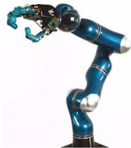
FIGURE 2 – Robot manipulateur à joints flexibles
