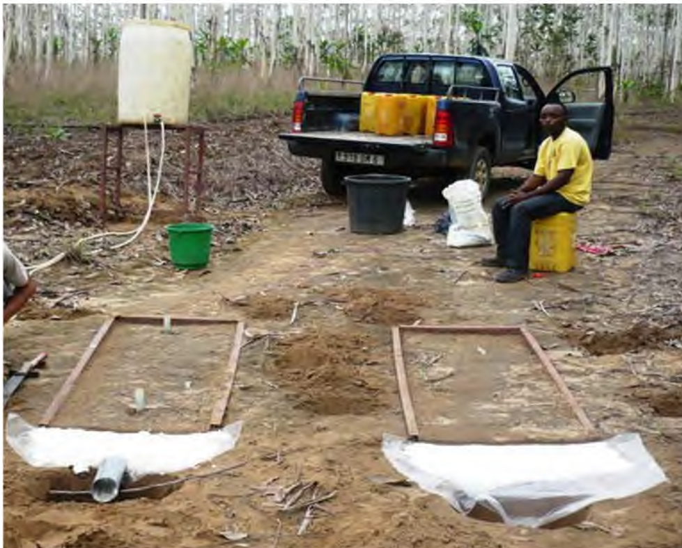
Photo 15 : Simulateur de pluie installé sur une piste à Kondi (Cliché Mayima, 2012)
