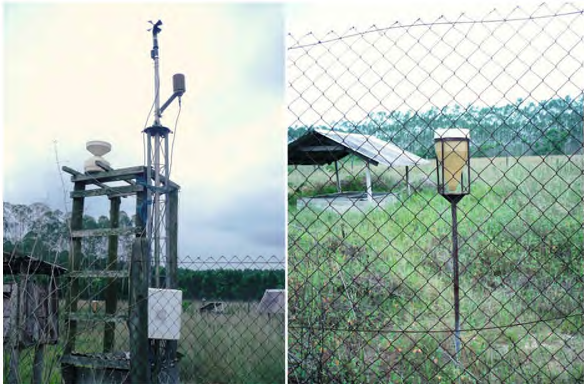
Photo 20 : Dispositif de mesure des données pluviométriques installés à Kondi par le CRDPI (Cliché Mayima ,2012)
