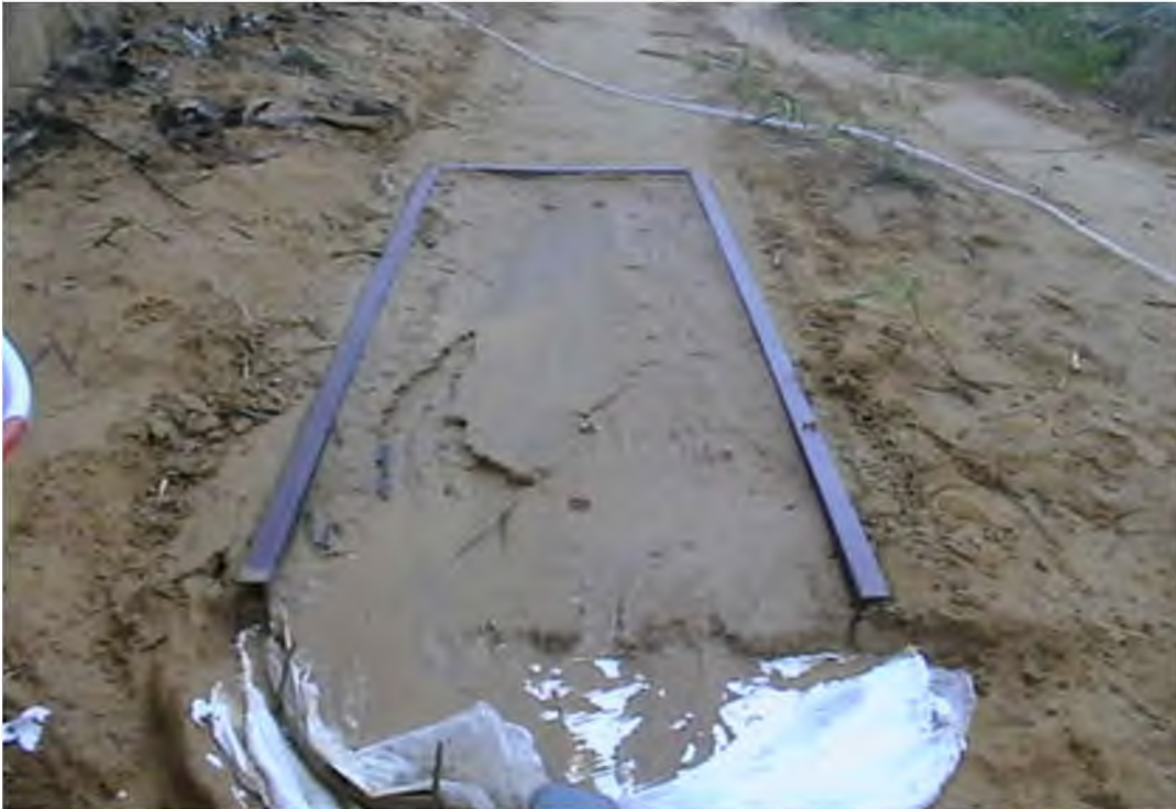
Photo 21 : Manifestation d'une rigole sur piste suite aux pluies simulées (Cliché Mayima, 2009)
