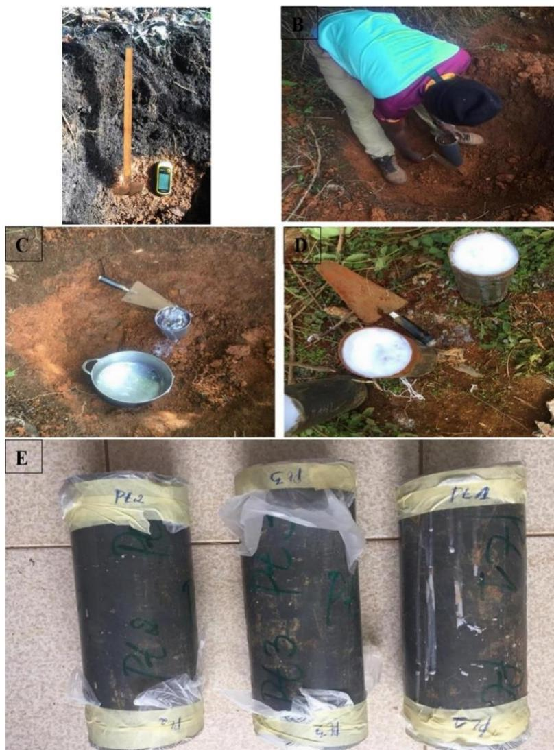
**Photo 2:** Les différentes étapes de prélèvement d'échantillonnage du sol.
