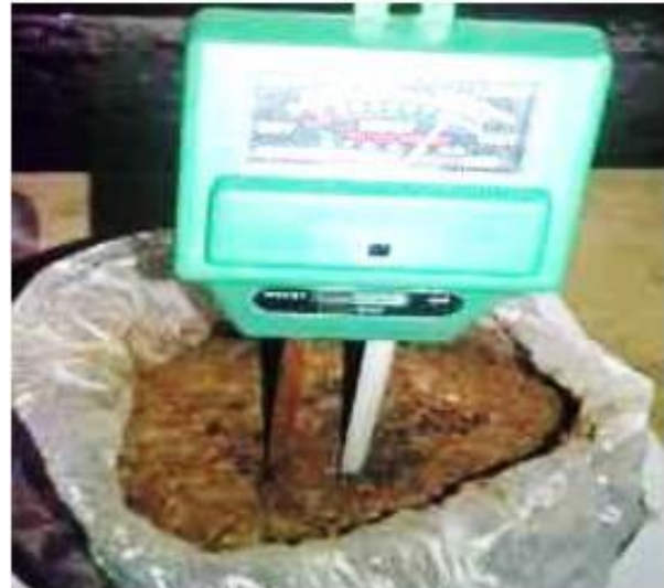
Figure 14 : Mesure taux d'humidité [85%]
