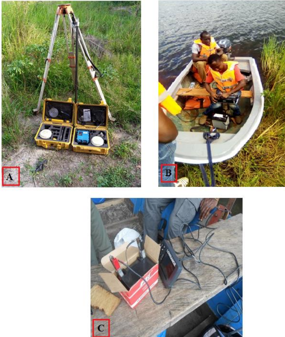
Figure 23 : Quelques outils de terrain : (A) GPS différentiel ; (B) Hors-bord ; (C) Echosondeur
