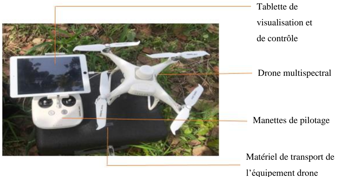
Figure 4 : Dispositif d'acquisition des images dans les exploitations de cacao
