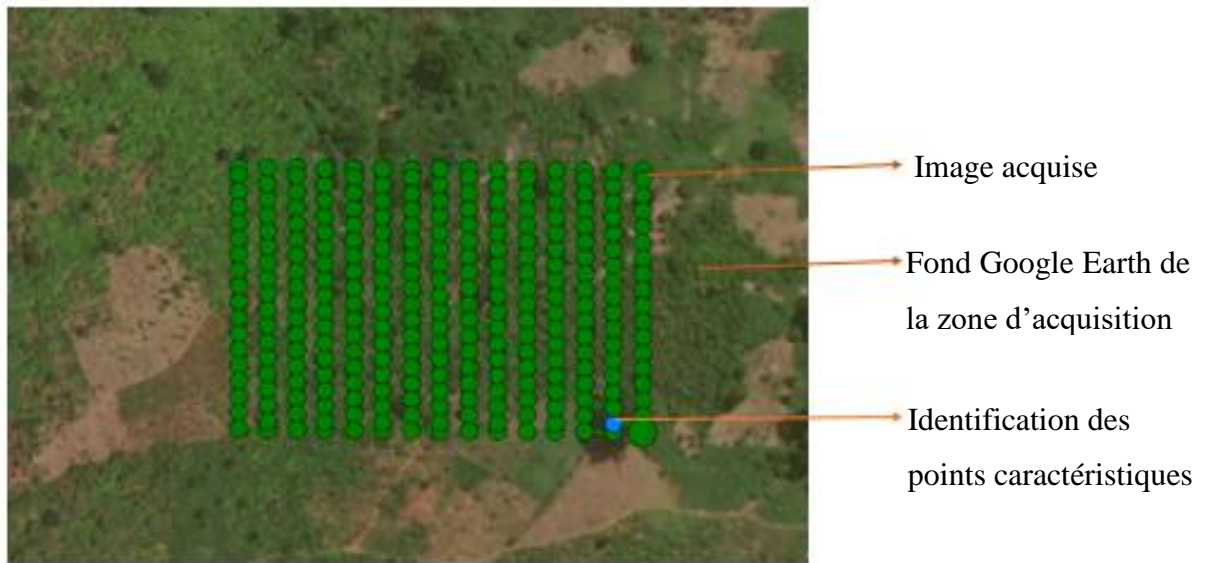
Figure 9 : Création des points d'attaches automatiques entre les images
