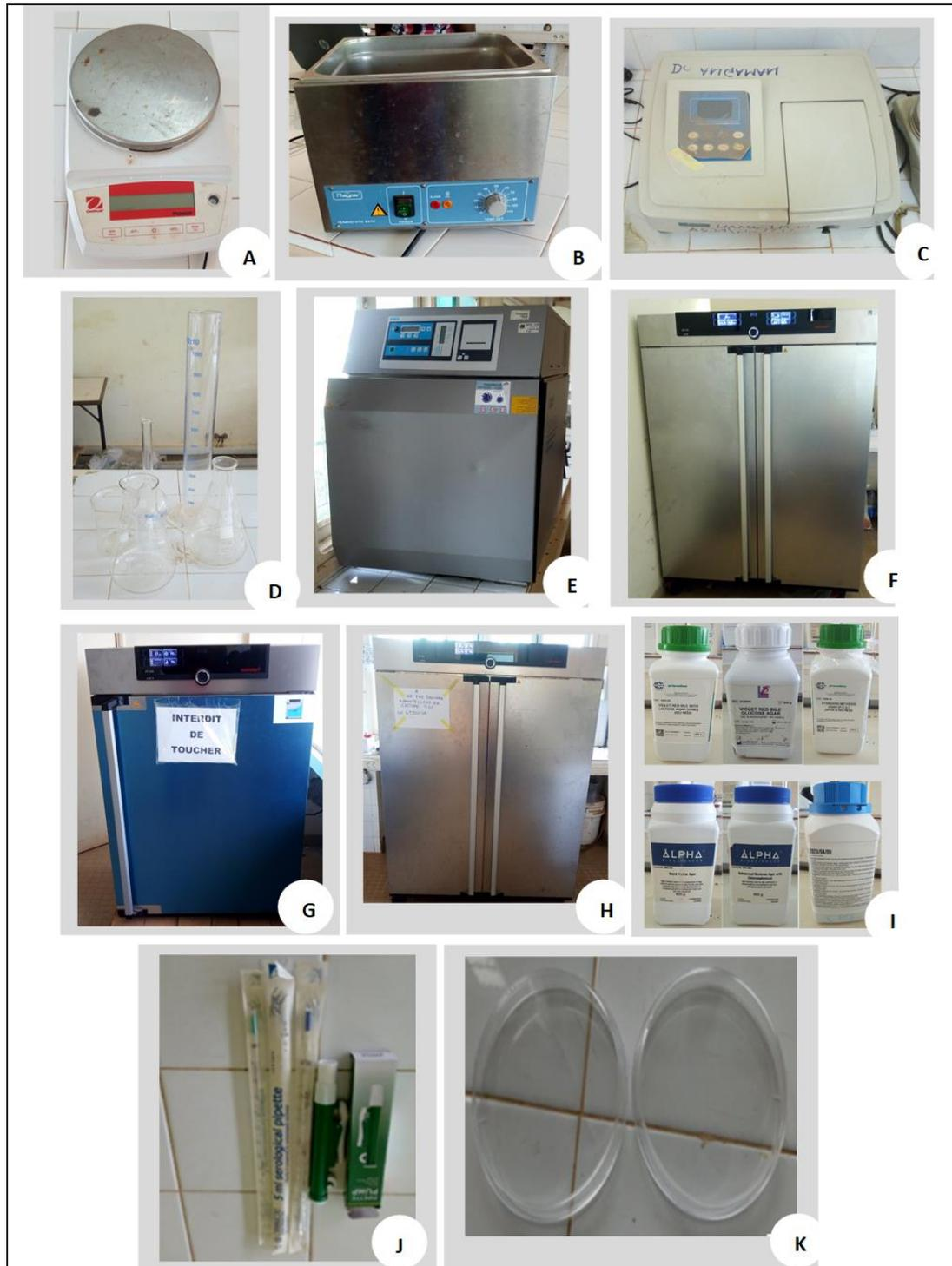
**A** : une balance (OHAUS<sup>®</sup>) ; **B** : un bain marie (Raypa<sup>®</sup>) ; **C** : un spectrophotomètre ; **D** : les verreries ; **E** : un autoclave (VARIOKLAV<sup>®</sup>) ; **F**, **G** et **H** : des étuves (Mettler) ; **I** : les différents produits chimiques utilisés ; **J** : des pipettes et des pro pipettes ; **K** : des boîtes de pétries. (Photographie Techno POP 1 Pro)
