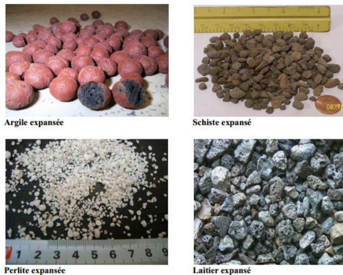
Figure 20 : Granulats légers artificiels (Le Hung NGUYEN, 2013)
