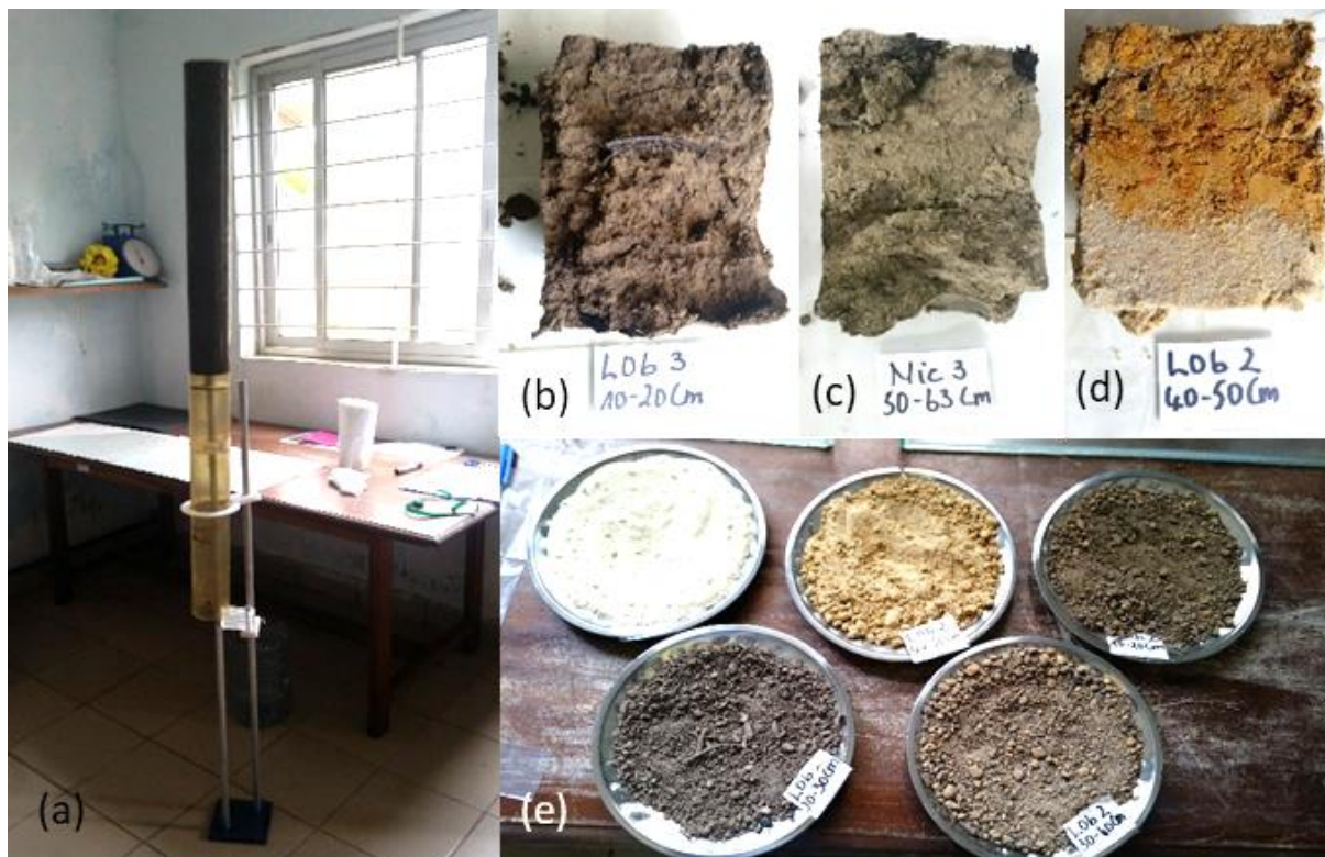
Figure 13. Découpage des carottes en laboratoire : (a) Support de découpage, (b, c et d) Tranches de sédiments découpés, (e) Séchage d'échantillons.
