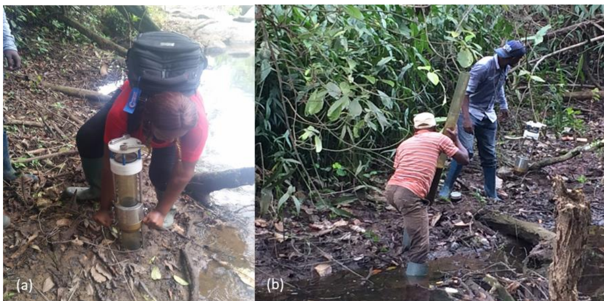
Figure 11. Prélèvement des carottes de sédiment : (a) Enfoncement du tube, (b) carotte prélevée.
