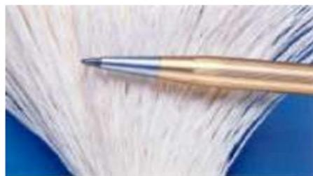
Figure 14 : Des milliers de fibres à membrane creuses
