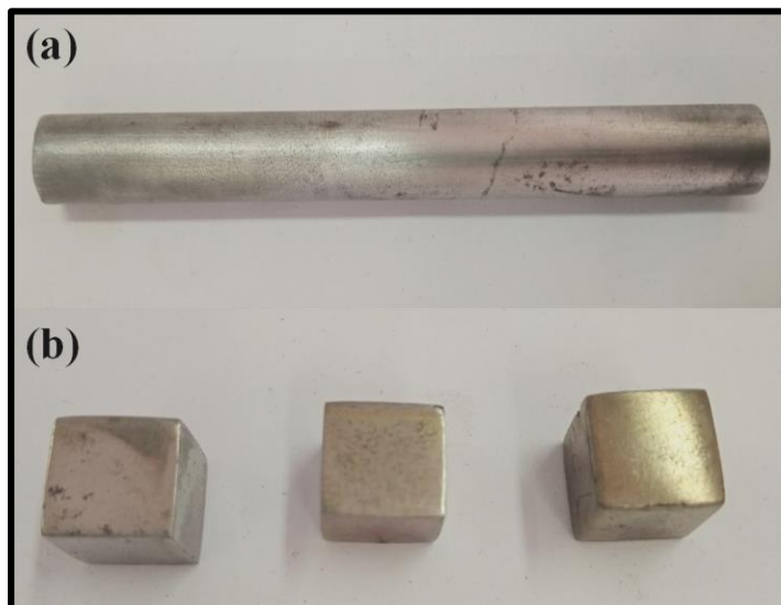
Figure 18. Echantillons cylindrique (a) et cubique (b) d'acier XC38
