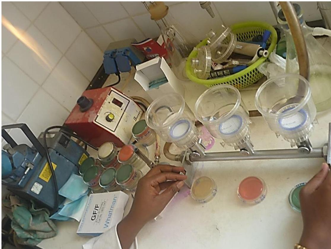
**Figure 10 :** Concentration des échantillons d'eau sur membranes filtrantes (photo par DAMMI, 2017)
