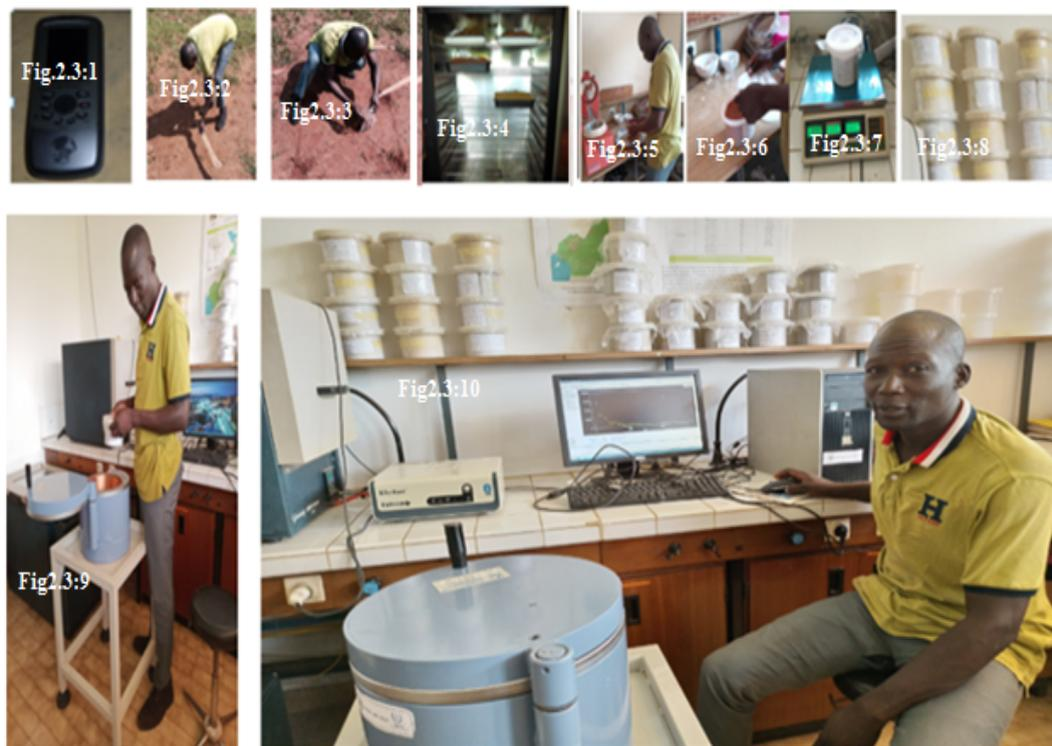
**Figure 2.3** – Mesure de la radioactivité : échantillonnage, conditionnement et analyse des échantillons de sol.
