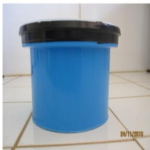
**Figure 2.4** – Marineli Beaker contenant la source liquide radioactive de l'AIEA utilisée pour l'étalonnage en efficacité de la chaîne de détection de la spectrométrie  $\gamma$  en laboratoire [92].
