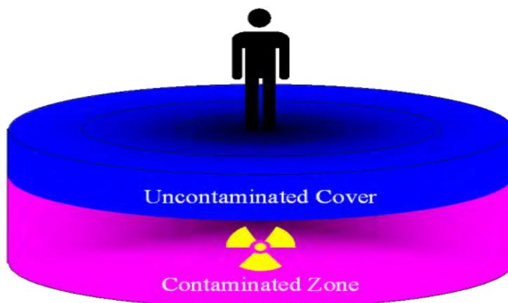
**Figure 2.10** – Épaisseur de la couche de couverture pour le facteur de transport environnemental [119].
