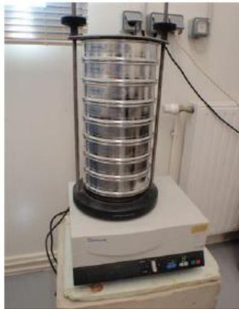
**Figure 3.5.** Colonne de tamis et tamiseuse.
