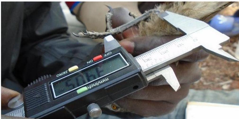
**Figure 11** : mensurations sur des taxons au travers d'un pied à coulisse (marque ELG)
