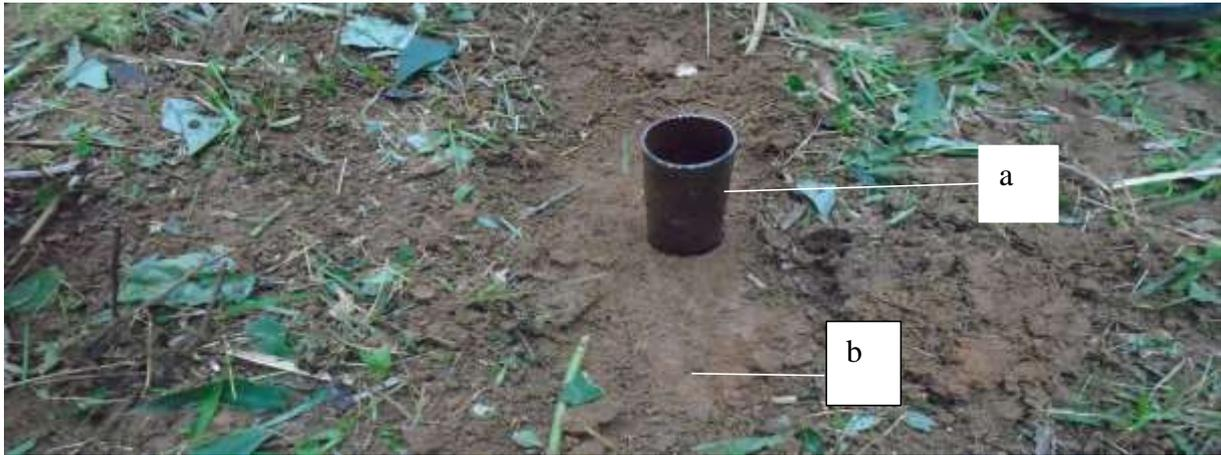
Fig. 14. Dispositif pour le prélèvement des échantillons de sol en vue de l'évaluation de la densité apparente (a : tube métallique ; b : sol excavé)
