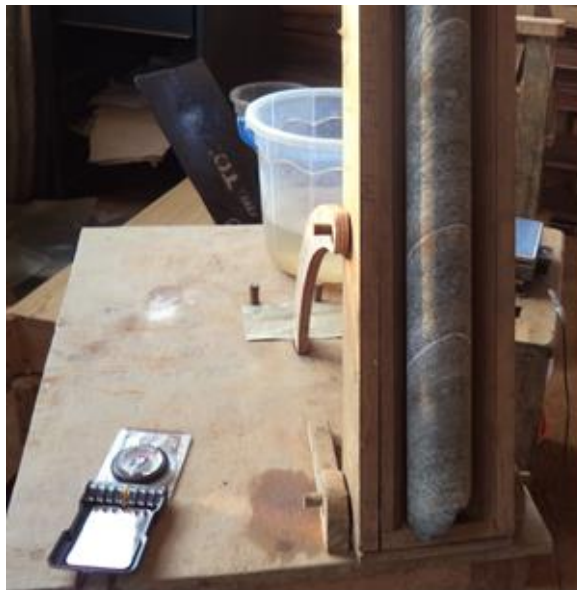
Figure 13. Méthode de mesure structurale sur table
