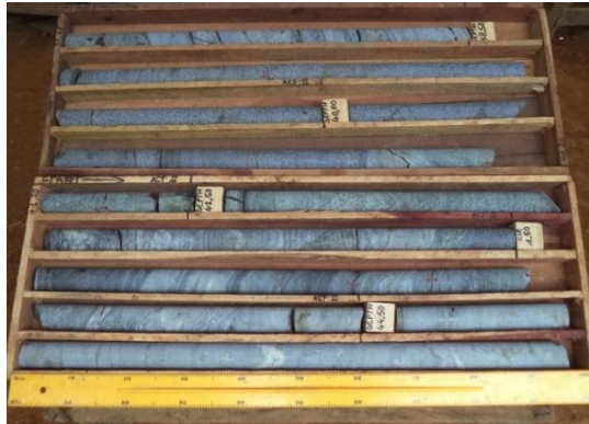
Figure 17. Illustration d'un contact graduel (38,50 m et 41 m) entre les FFG et les gneiss mafiques ainsi que le contact direct entre les gneiss mafiques (44 m) et les gneiss felsiques dans le forage TNDF08_04 à l'intervalle 37,65 à 45, 80 m
