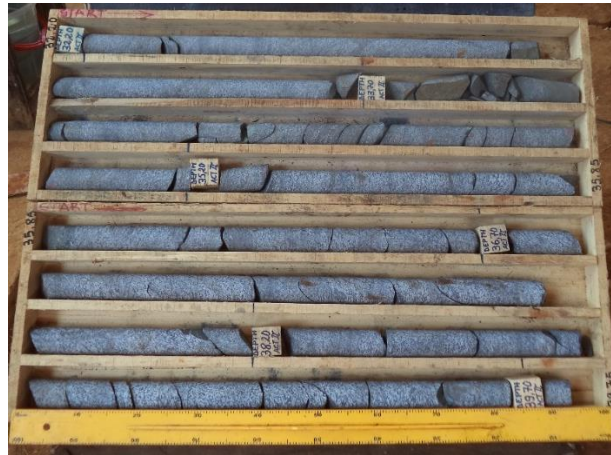
Figure 16. Unité des FF du forage TNDF08_03 à l'intervalle de 32,20 à 39,75 m de profondeur.
