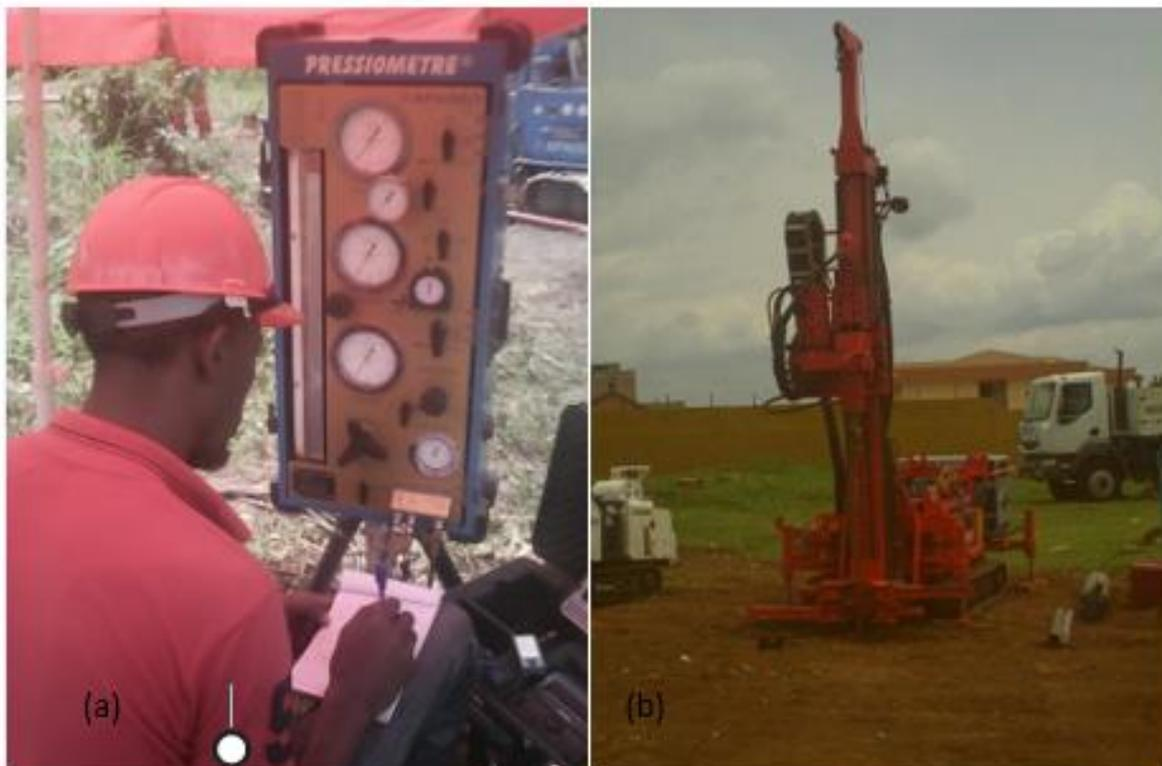
**Figure 2-7 :** Pressiomètre de Menard (a) et tarière mécanique (b).
