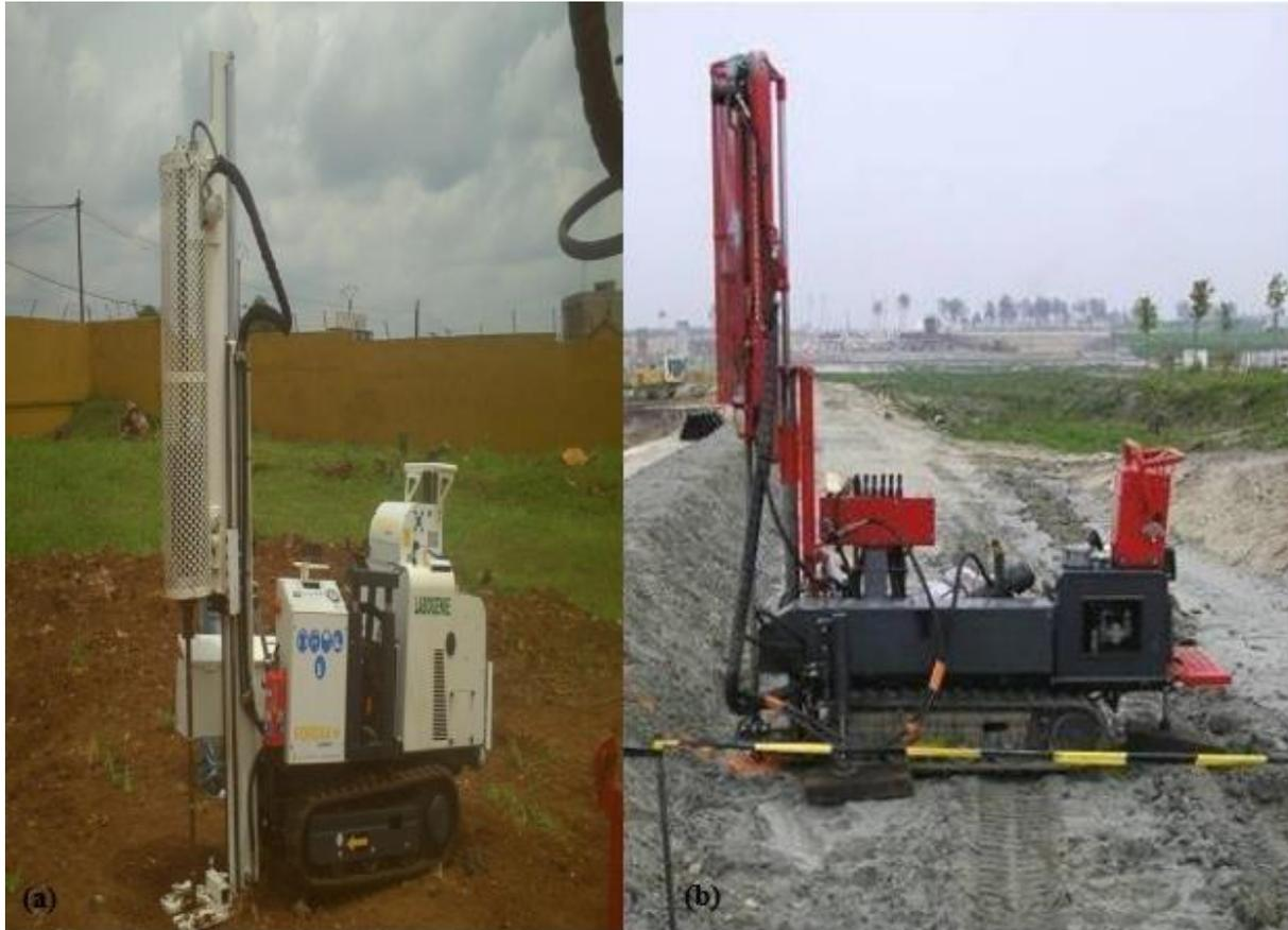
**Figure 2-6 :** Deux types du pénétrömètre dynamique lourd : (a) type A (FORDIA) ; (b) type B (GEOTOOL).
