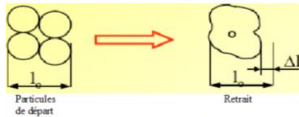
Figure 6: Frittage associé à une densification du matériau
