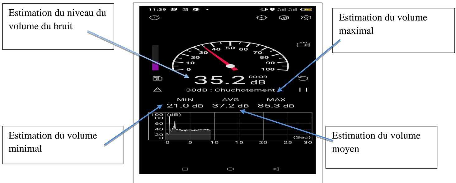
**Figure 5:** Interface du sonomètre de collecte des données acoustiques sur un site éloigné de l'autoroute (Ymelon 2021)
