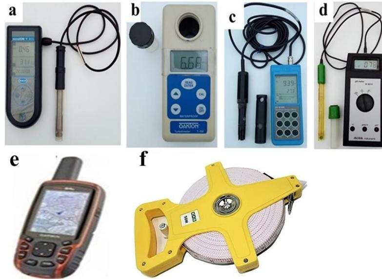
**Figure 3** : Matériel de mesure des paramètres physico-chimiques ; **a** = Conductimètre *HACH SensION + EC 5*; **b** =Turbidimètre *OAKTON T-100*; **c** = Oxymètre *HANNA*; **d** = pH-mètre *HANNA* ; **e** = Global Positioning Systems (GPS) *GARMIN* ; **f** = décamètre *KAIDA*.
