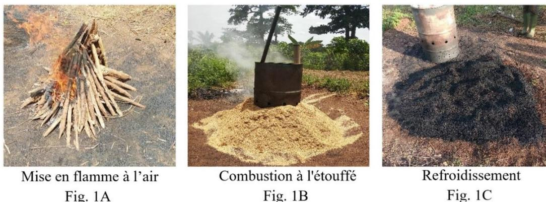
**Fig. 1. Processus de carbonisation d'un substrat**
