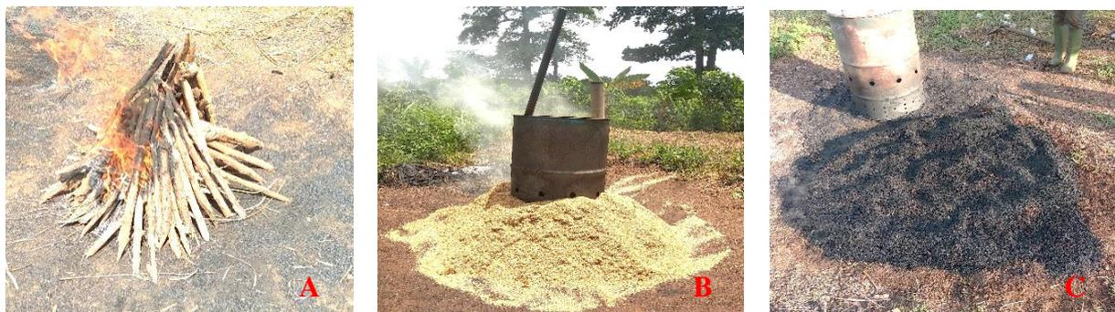
Figure 23 : Etape du processus de carbonisation d'un substrat
