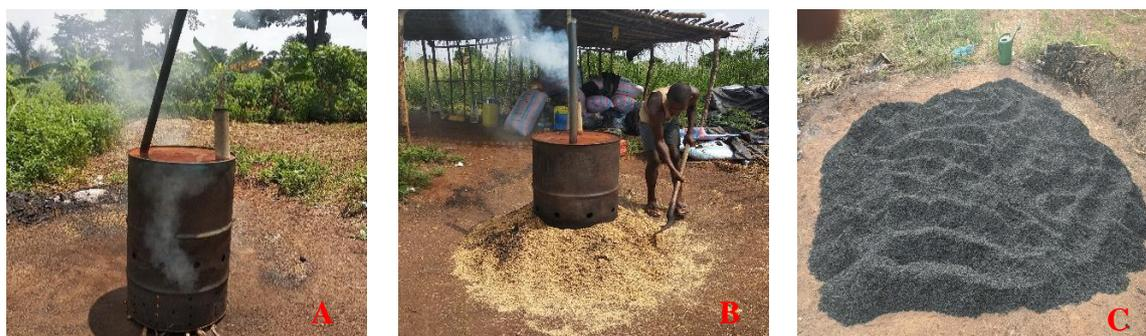
**Figure 5 :** Carbonisation d'un substrat, mise en flamme à l'air (A), combustion à l'étouffé (B), refroidissement (C)
