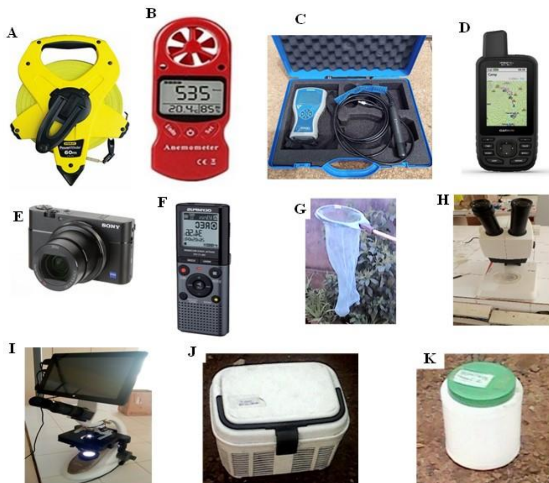
Figure 12 : Matériel de collecte des paramètres physiques, des amphibiens et des helminthes parasites. A : Décamètre ; B : Thermo-hygromètre ; C : Multi-paramètre ; D : Appareil GPS ; E : Appareil photo-numérique ; F : Dictaphone ; G : Filet troubleau ; H : Loupe binoculaire ; I : Microscope optique à caméra ; J : aquarium plastique ; K : boîte de capture.
