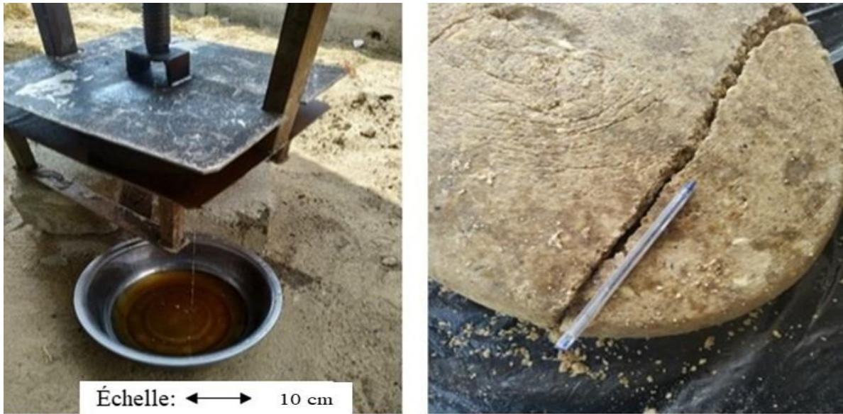
Figure 13 : Pressage et extraction de l'huile d'amande de cajou
