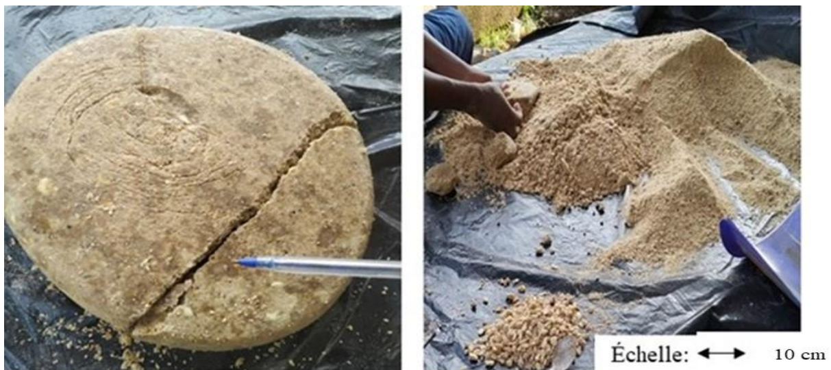
Figure 14 : Concassage des blocs de tourteaux humides de cajou
