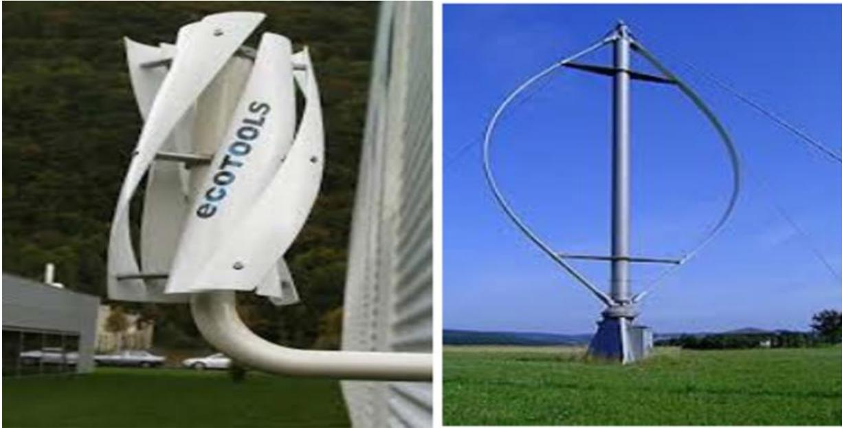
**Figure 26 : Eolienne à axe vertical: Savonius et Darrieus [30]**
