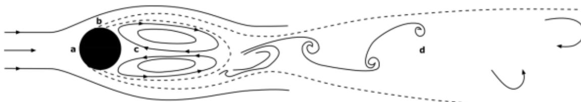
**Figure 13:** Différentes zones caractéristique d'un écoulement autour d'un obstacle cylindrique
