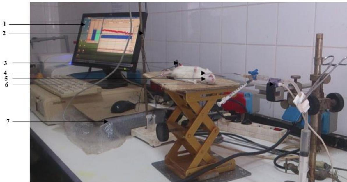
1 : écran d'ordinateur ; 2 : électrodes ; 3 : canule pénienne, 4 : canule carotidienne ; 5 : rat mâle ; 6 : transducteur de signal ; 7 : biopac MP 35
