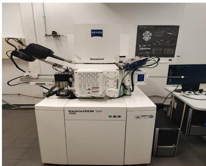
**Figure 24:** Microscope électronique à balayage (MEB)
