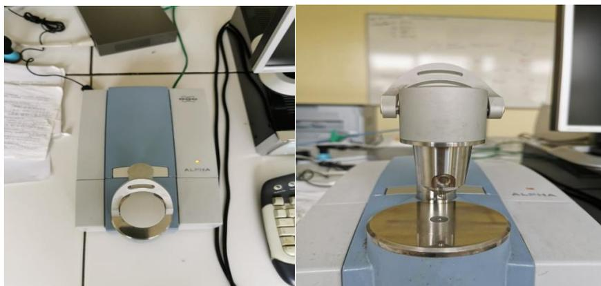
**Figure 18:** Spectromètre infrarouge à transformée de Fourier
