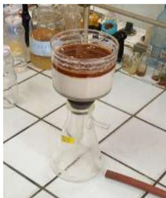
**Figure 117:** Montage VLC sur RP18
