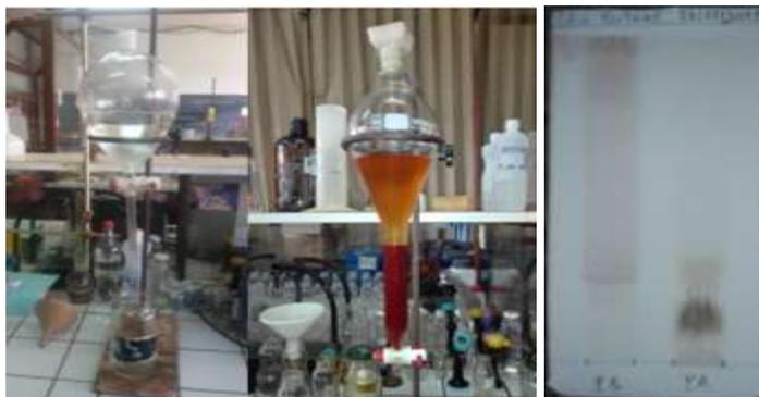
**Figure 116:** Partition au *n*-BuOH saturé d'eau (montage + CCM)
