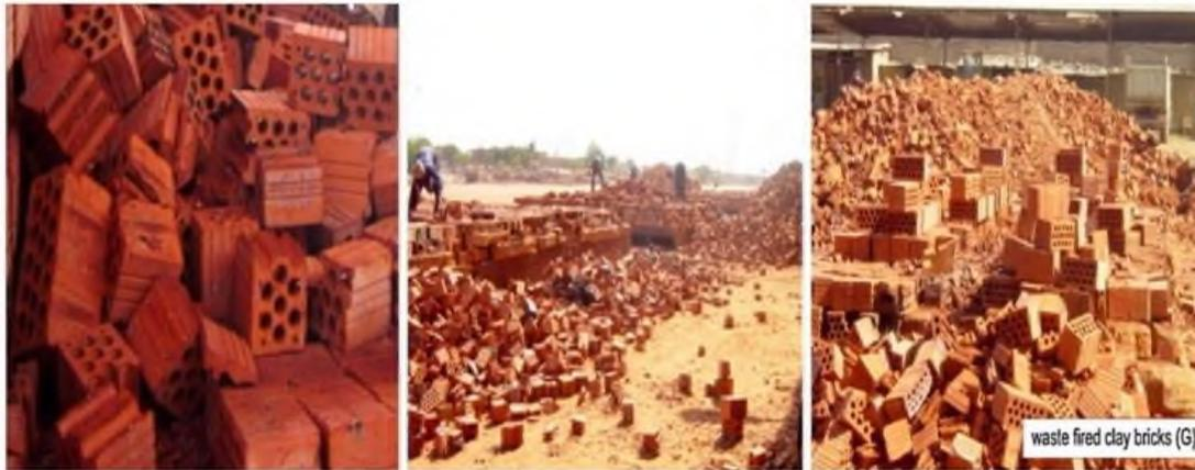
**Figure 1** : Déchets de fabrication des briques de terre cuites (Zawrha et al., 2016).
