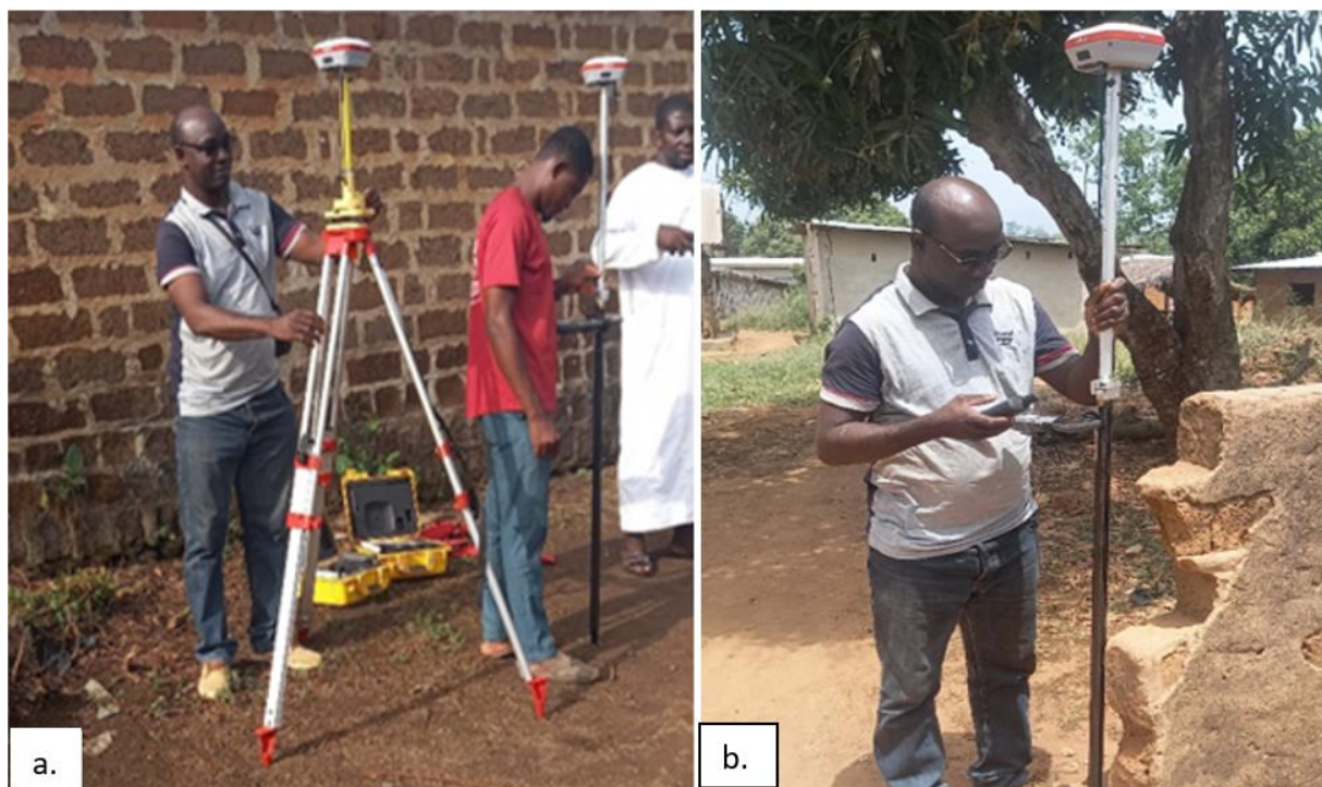
Figure 30 : Principe d'installation du GPS Différentiel
