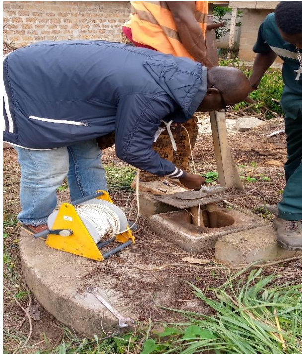
Figure 24 : Mesure de niveau d'eau dans un forage hors usage à Yapleu en 2020
