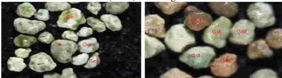
**Fig. 9.** Glauconites allochtones délavées avec des grains blanchis (A-30m : GX3 et B-25m : GX6. Gst : glauconites saines transportées, Got : glauconites oxydées transportées) et des grains microexfoliés (Ge).
