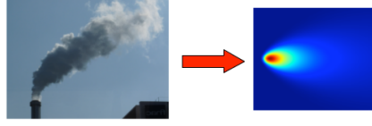
FIGURE 1.9 – Modèle gaussien de panache stationnaire : le panache émis par une cheminée est représenté par une distribution gaussienne dans deux directions. A gauche : photo de panache issu d’une cheminée (crédit : Yelva Roustan). A droite : exemple de sortie du modèle de panache gaussien de Polyphemus.
