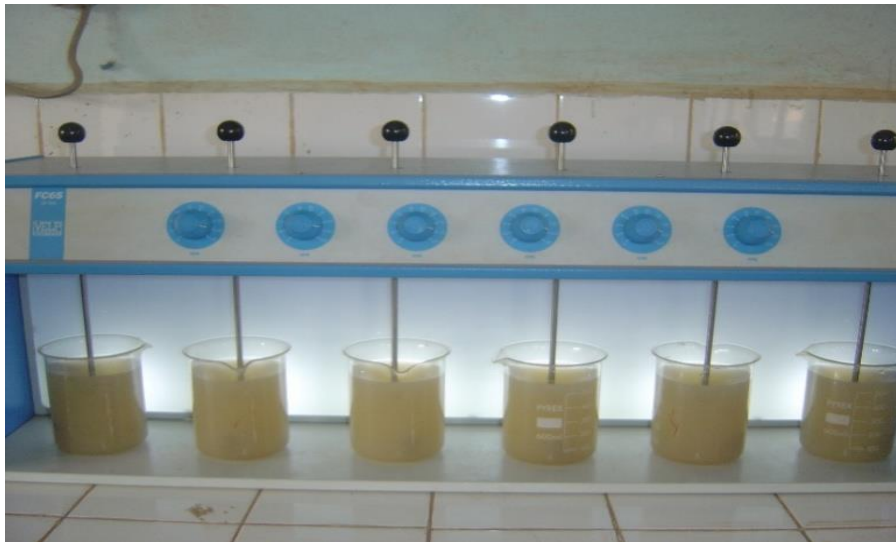
Figure 11 : Flocculateur FC6S Velp Scientifica Jar-Test : Essai de clarification en jar test des échantillons d'eau (Photo Kaboré, 2013).
