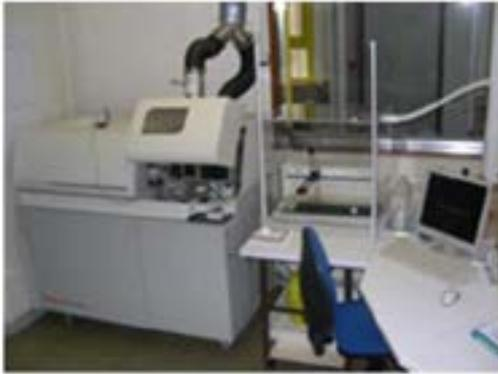
Spectromètre d'émission (ICP-OES)
