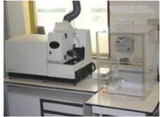
Spectromètre de masse (ICP-MS)
