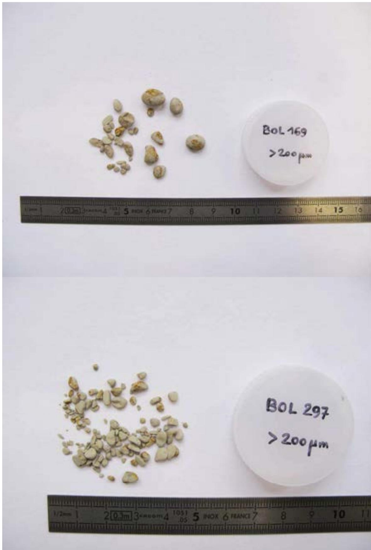
Figure 4.7. Granules d'argiles de l'échantillon Bol 169 (en haut) et Bol 297 (en bas) après tamisage et séparation de la fraction supérieure à 200  $\mu\text{m}$ .
