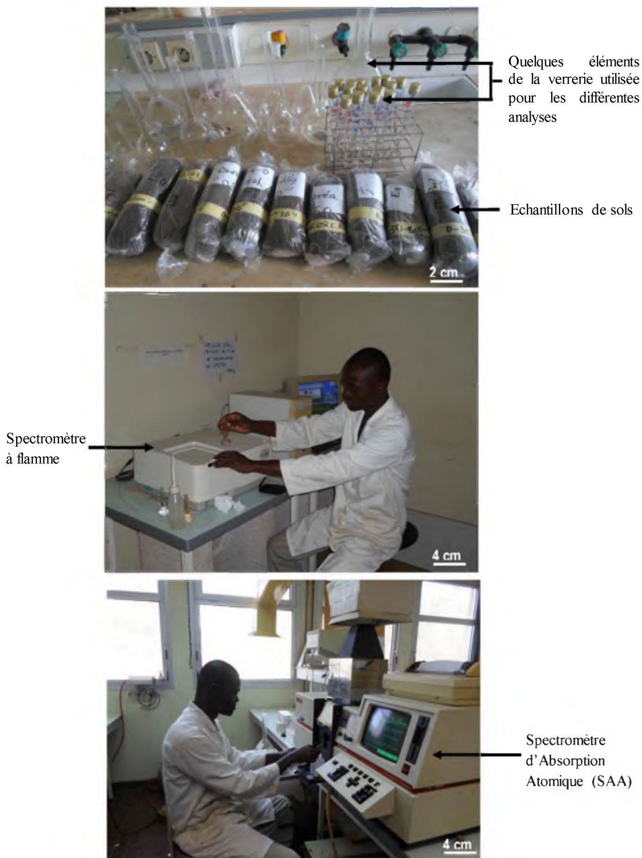
Figure 22 : Quelques éléments de la verrerie et appareils pour les différentes analyses de laboratoire.
