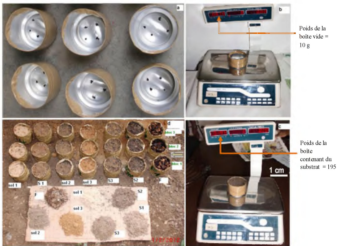
a = boîtes en aluminium perforées à la base, b = pesée de la boîte (10 g); c = pesée du substrat fabriqué et d = indications des différents traitements et dispositif en bloc de Fischer.
